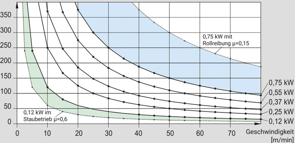
Beispielhafter Einfluss auf die zulässige Gesamtlast und Geschwindigkeit, wenn sich der Reibwert von einem Gurtförderer ( $\mu=0,3$ ) zu einer Rollenbahn ( $\mu=0,15$ ) halbiert
